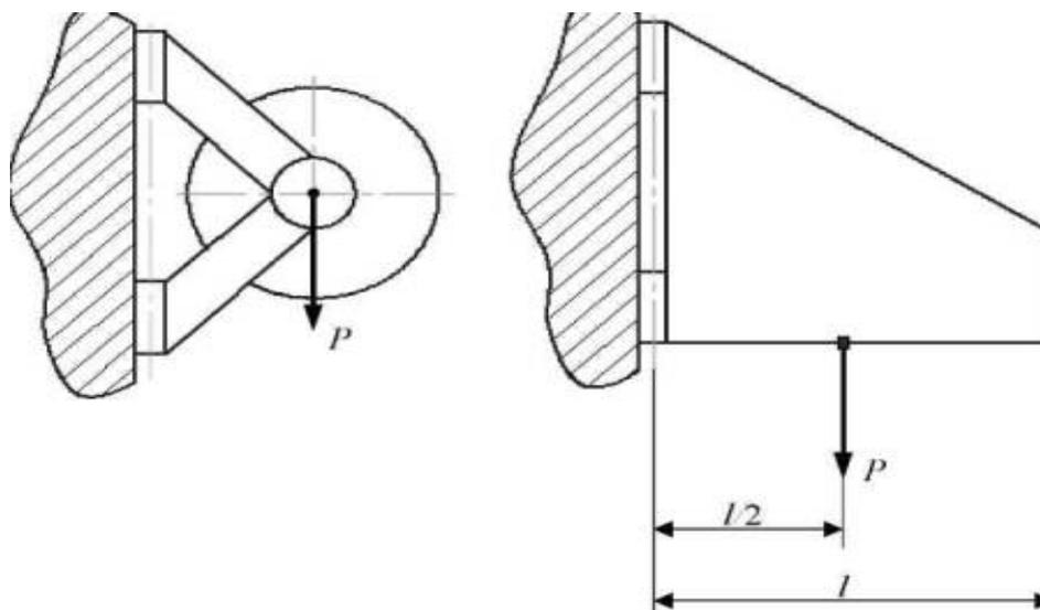
Рисунок 1 - Схема приложения нагрузки  $P$  к рукавной кассете
